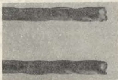
Rys. 4. Spiralne rozwarstwienie drutu sprężynowego po próbie skręcania
