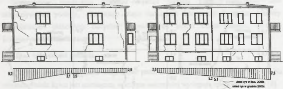
Rys. 3. Uszkodzenia obiektu widoczne na elewacjach Fig. 3. Damage of building on facades
