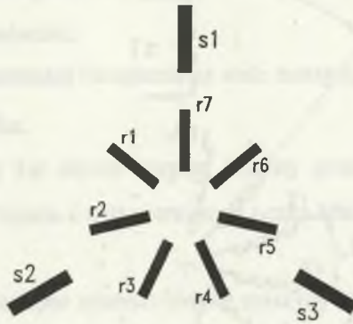
Rys. 1.4. Schemat ideowy 3-fazowej maszyny klatkowej o liczbie żłobków wirnika Q_r=7 ( Q_r - liczba nieparzysta).
