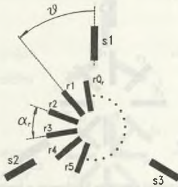
Rys. 1.3. Schemat ideowy 3-fazowej maszyny klatkowej (umowna reprezentacja uzwojeń fazowych) Fig. 1.3. Schematic representation of 3-phase squirrel-cage machine (simplified representation of phase windings)
