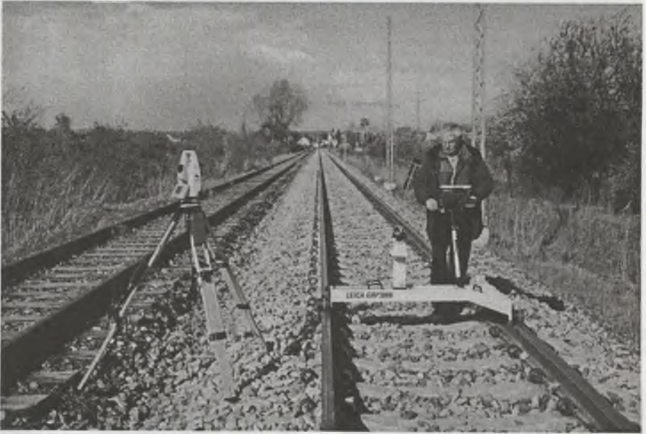
Rys.3. Pomiar wózkiem GPR3000 na odcinku testowym Fig.3. Measuring trolley GPR3000 on the test section
