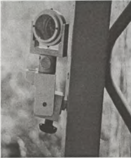
Rys.5. Lustro dalmiercze na znaku regulacji osi toru Fig.5. Range-finder glass prism on the railway track axis sign
