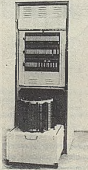
Rys. 1. Widok ogólny pamięci bębnowej PB-5
