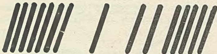
Rys. 10. Efekt nieprostopadłości osi symetrii szczeliny głowicy względem kierunku rejestracji
