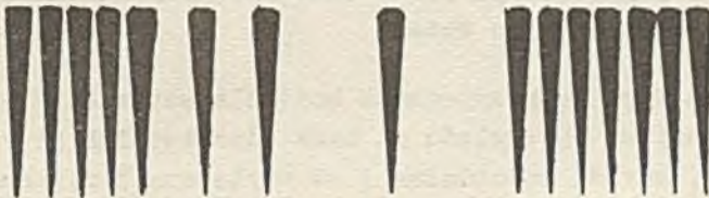
Rys. 9. Efekt nierównoległości płaszczyzny czoła szczeliny głowicy i powierzchni nośnika
