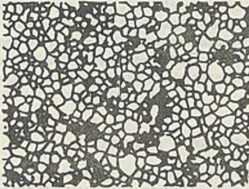
Rys. 1. Zdjęcie metalograficzne ferrytu niklowo-cynkowego, drobnoziarnistego /powiększenie x 600/
