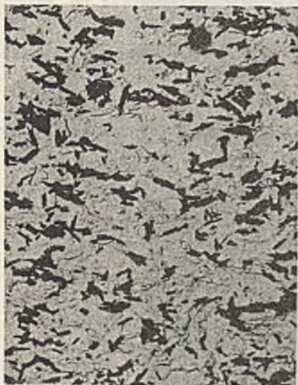
Rys. 7. Układ spolaryzowanych ziaren \gamma - \text{Fe}_2\text{O}_3 przy powierzchni warstwy magnetycznej
