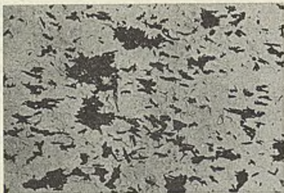
Rys. 12. Powierzchnia warstwy magnetycznej przy taśmie nośnej. Powiększenie 7500 razy
