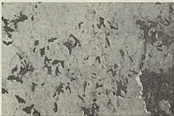
Rys. 9. Układ spolaryzowanych ziaren \gamma\text{-Fe}_2\text{O}_3 przy powierzchni warstwy /powiększenie 5000 razy/
