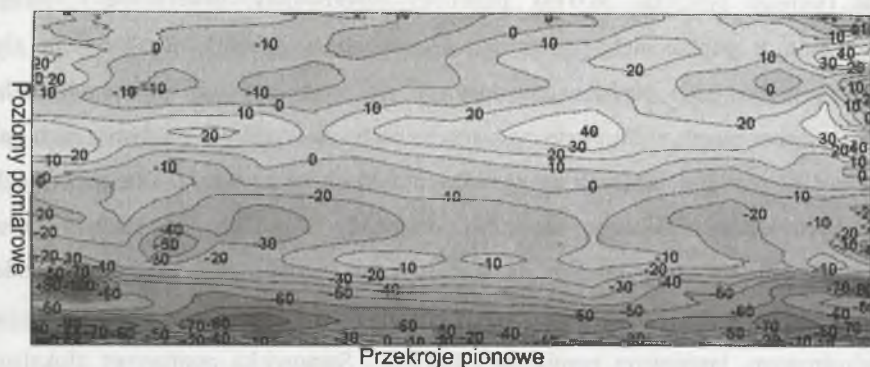
Rys. 1. Imperfekcje geometryczne chłodni kominowej [mm] wyznaczone metodą płaską Fig. 1. Geometrical imperfections of cooling tower [mm] calculated with the planar method
