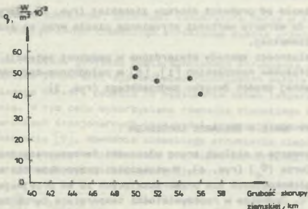
Rys. 2. Korelacja ziemskiego strumienia ciepła od grubości skorupy ziemskiej obszaru lubelskiego
