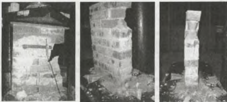
Rys. 8. Obraz zniszczenia modeli badanych Fig. 8. View of the failure of some test specimens
