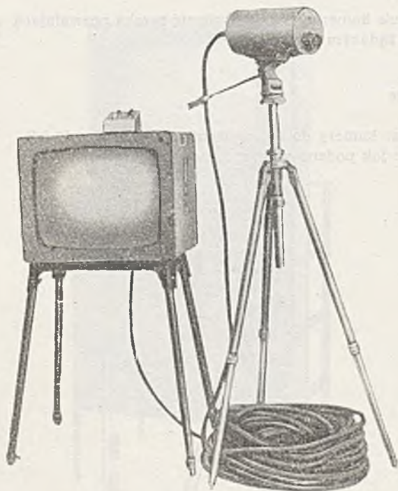
Rys. 1. Zestaw toru kamerowego, w którym wykorzystano statyw do zamocowania kamery
