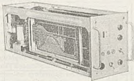
Rys. 1. Przełącznik generatorów synchronizujących PG-0041
