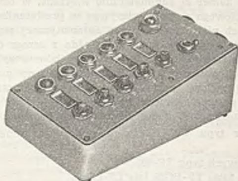
Rys. 5. Pulpit przełącznika kamer TP-PS50
