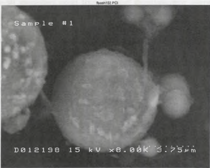
Rys. 3. Początkowe stadium połączeń międzyziarnowych, Pr 1 (2003), powiększenie 3,75 \mu\text{m}=0,000375 \text{ cm}
