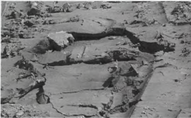
Rys. 3. Naturalny proces wysychania ropy po odsłonięciu dna wykopu (po 2 godzinach), rozwinięta makrodezintegracja powierzchniowa
