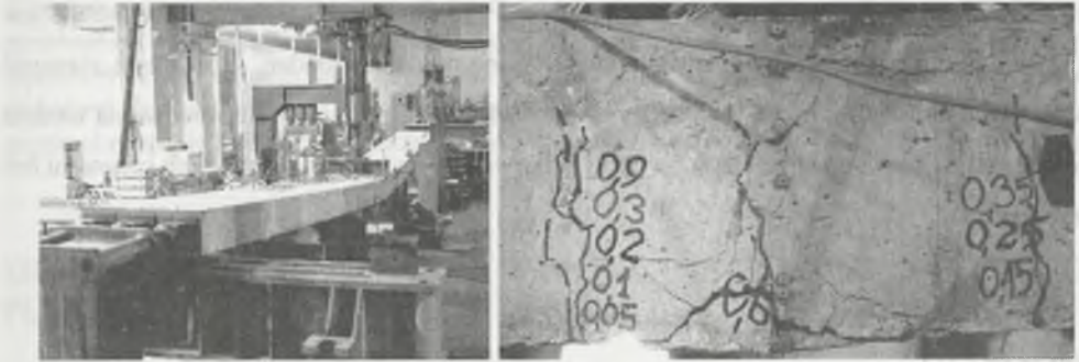
Rys. 4. Widok stanowiska badawczego i obraz płyty w stanie zniszczenia
