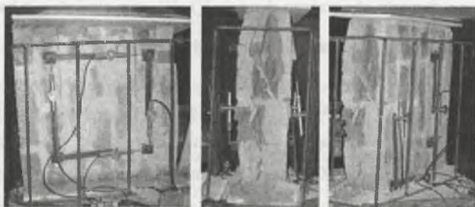
Rys. 5. Obraz zniszczenia modeli obciążonych prostopadłe do spoin wspornych Fig. 5. Failure of specimens loaded perpendicular to bed joints
