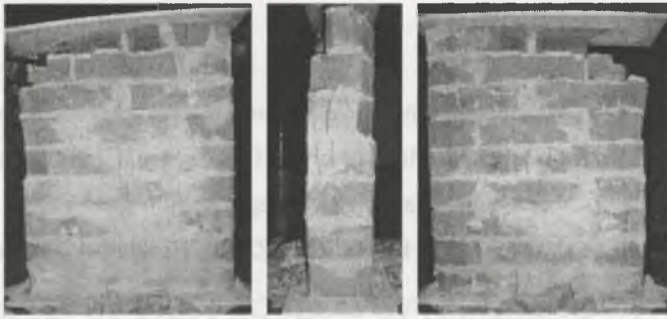
Rys. 6. Obraz zniszczenia modeli obciążonych równoległe do spoin wspornych Fig. 6. Failure of specimens loaded parallel to bed joints
