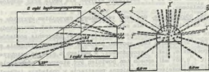
Rys. 8. Szkic rozmieszczenia otworów w metodzie hydrowymywania węgla zza półki skalnej w przodku przekopu 3. poz. -260 m w polu "Piaś" kop. "Nowa Ruda"
