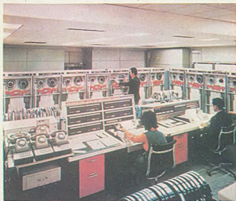
Fot. V. Stacje taśm magnetycznych ustawiono w tym ośrodku obliczeniowym wokół pulpitu operatorskiego dużego komputera
