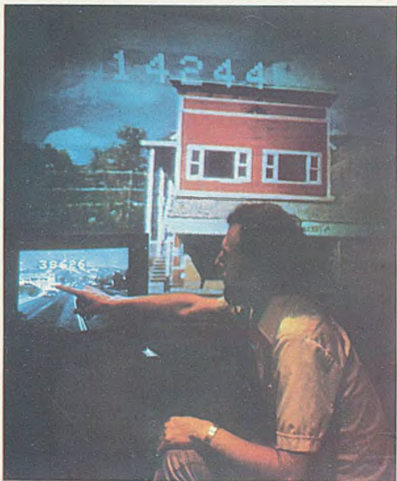
Fot. III. Wskazując palcem na monitorze wybrany budynek, otrzymujemy na dużym ekranie jego obraz od frontu
