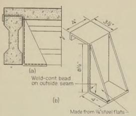
REQUIREMENTS FOR PRECAST CONCRETE FLOOR UNITS (ACI 711-46)
