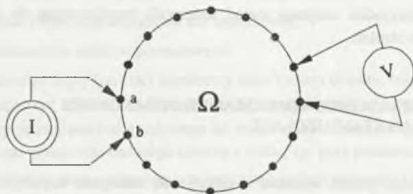
Rys.2. Idea elektrycznej tomografii impedancyjnej: I — prąd zasilający, a, b — elektrody zasilające, ••• — elektrody pomiarowe
