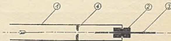
Rys. 1. Szemat urządzenia pomiarowego. 1 — rura, 2 — dławik, 3 — lina, 4 — dysza.
