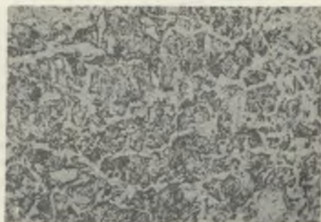
Rys. 13. Struktura staliwa L30H (125x)
