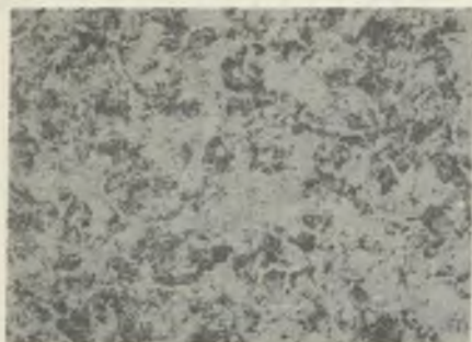
Rys. 12. Struktura staliwa 45LII (125x)
