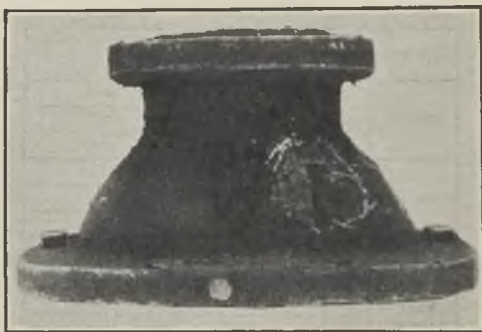
FIG. 9.—"BLIND" OR "DUMB" SCAB.
