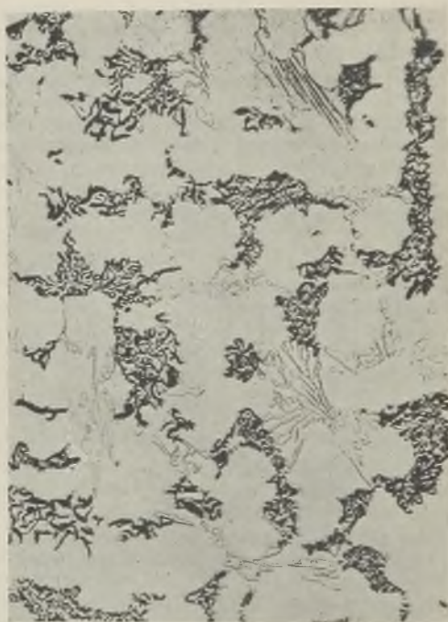
FIG. 4.—“ Nicrosilal ”—AN AUSTENITIC CAST IRON. \times 200 .
