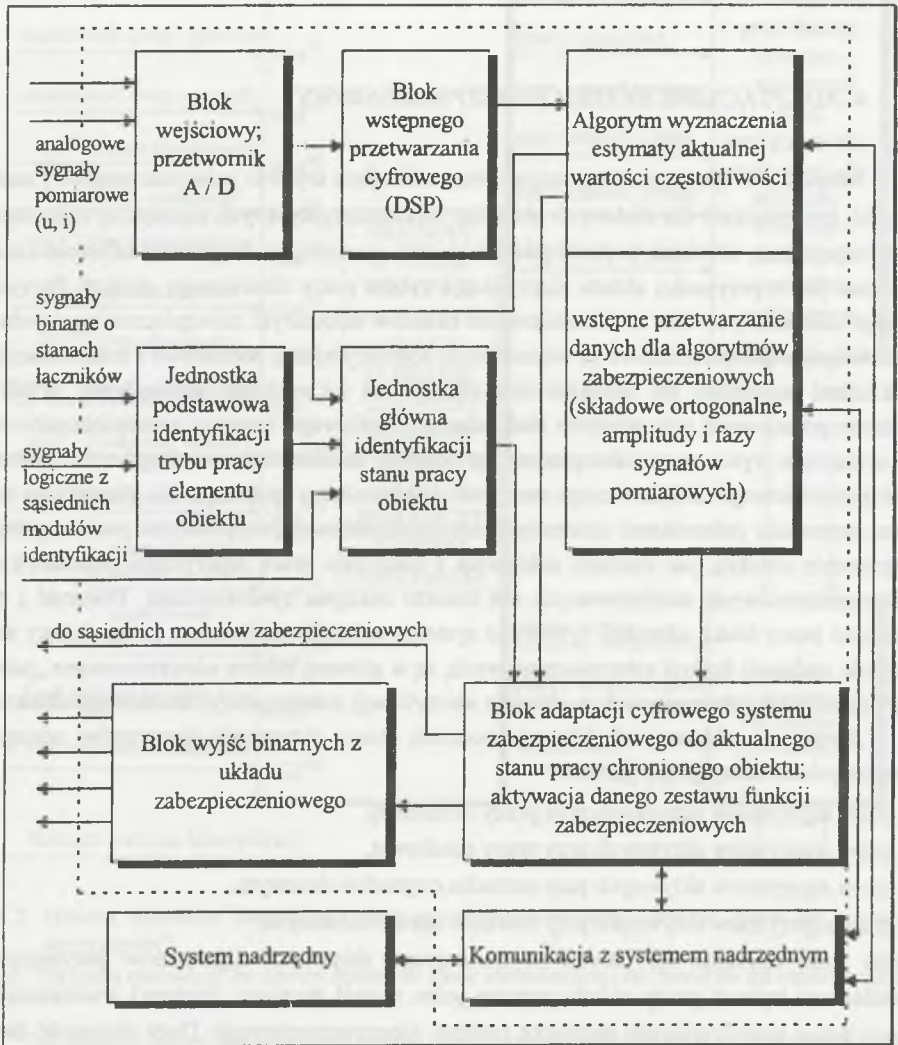
Rys. 3. Schemat blokowy fragmentu cyfrowego systemu zabezpieczeniowego realizującego kryteria: struktury, zabezpieczeniowe i adaptacyjne dedykowany maszynie synchronicznej
