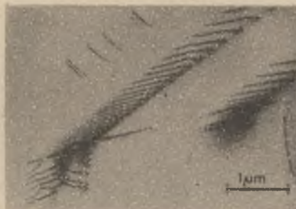
Rys. 110. Struktura po przesyceniu z temperatury 1323 K/0,5 godz. i starzeniu w temperaturze 873 K/15 godz. Spiętrzenie dyslokacji sugerujące tworzenie bliźniaków
