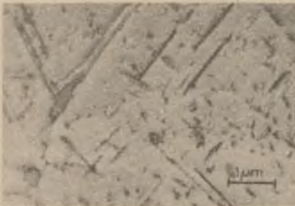
Rys. 103. Struktura po przesycaniu z temperatury 1223 K/0,5 godz. i następnym starzeniu w temperaturze 873 K/300 godz.
