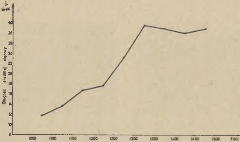
Rys. 55. Wpływ temperatury przesycania na średnią wielkość ziarna (wytop 9)
