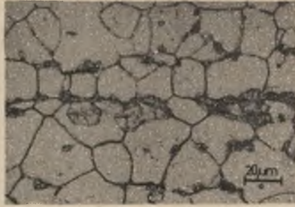
Rys. 95. Struktura po przesycaaniu z temperatury 1223 K/0,5 godz. i następnym starzeniu w temperaturze 773 K/300 godz.
