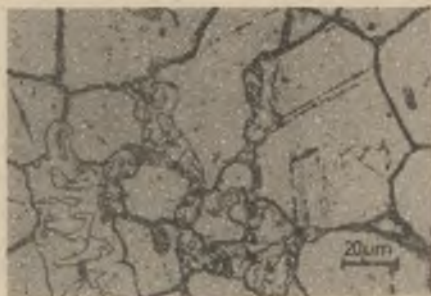
Rys. 99. Struktura po przesycaniu z temperatury 1223 K/0,5 godz. i następnym starzeniu w temperaturze 823 K/300 godz.
