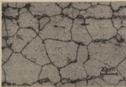
Rys. 97. Struktura po przesycaaniu z temperatury 1223 K/0,5 godz. i następnym starzeniu w temperaturze 823 K/50 godz.
