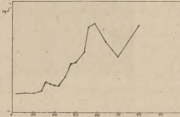
Rys. 135. Przebieg zmian dekrementu tłumienia stopu 60G30J9 po przesyca- niu z temperatury 1223 K (wytop 9)
