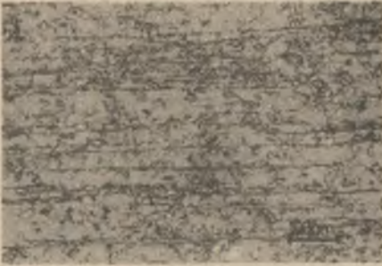
Rys. 46. Struktura austenityczno-ferrytyczna o średniej cięciwie ziarna austenitu 11,8 \mu\text{m} oraz ilości 12% ferrytu. Temperatura przesycania 1073 K/0,5 godz.-woda
