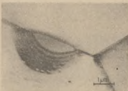
Rys. 59. Struktura po przesyca- niu z temperatury 1223 K/0,5 godz. - woda. W obszarze austenitu pojedyn- cze ziarno ferrytu o soczewkowym kształcie
