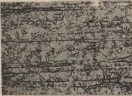
Rys. 50. Struktura austenityczno-ferrytyczna o średniej cięciwie ziarna austenitu 23,1 \mu\text{m} oraz ilości 15% ferrytu. Temperatura przesycania 1273 \text{ K}/0,5 \text{ godz.} - woda
