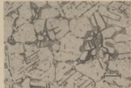
Rys. 104. Struktura po przesycaniu z temperatury 1223 K/0,5 godz. i następnym starzeniu w temperaturze 873 K/500 godz.
