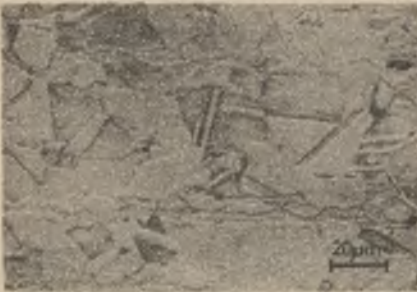
Rys. 132. Struktura austenityczno-ferrytyczna po starzeniu w temperaturze 823 K/500 godz. i następnym przesycaaniu z temperatury 1223K/0,5 godz.
