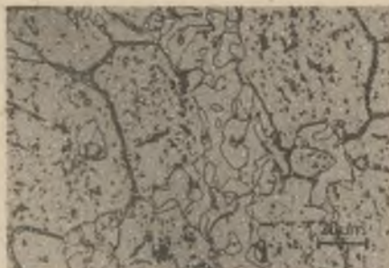
Rys.100. Struktura po przesycaniu z temperatury 1223 K/0,5 godz. i następnym starzeniu w temperaturze 823 K/500 godz.
