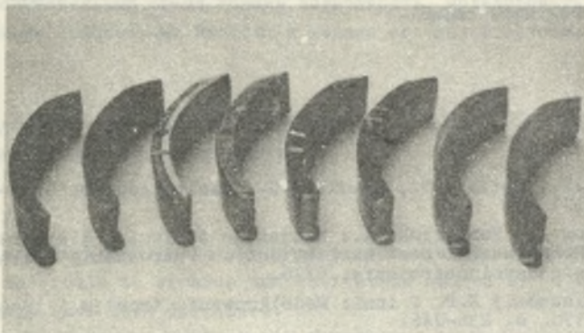
Rys. 9. Próbkki badanych materiałów St3, Sp4, LH18S2, Sp4 hart. po 10 godzinach pracy przy erozji piaskowej
