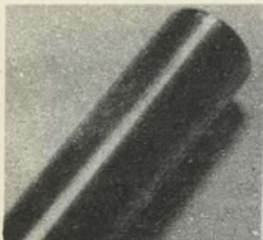
Rys. 4. Sonda d = 5 mm (z widocznym otworkiem impulsowym)
