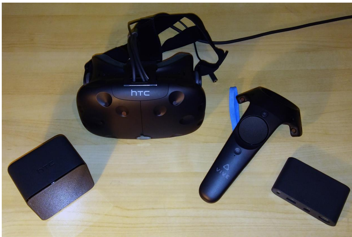
Rys. 1. Zdjęcie przedstawiające główne elementy zestawu wirtualnej rzeczywistości HTC Vive .
