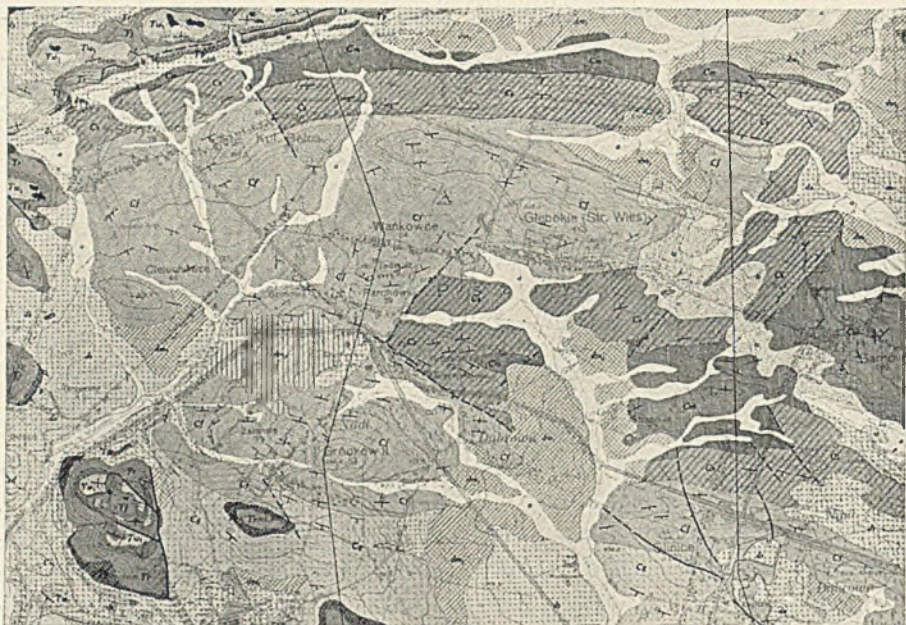
Rys. 115. Fragment mapy geologicznej śląskiego zagłębia węglowego ilustrujący zarysy terenu, który powinien być wyłączony z pod zabudowy, jako przeznaczony do przyszłej eksploatacji kopalnianej. / Geological fragmentary map of Silesian coal basin limiting the possibilities of town - planning.
