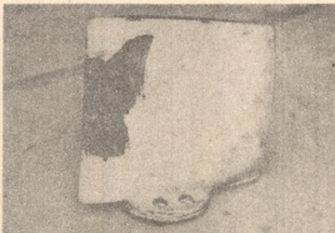
Rys. 120. Łopátka wentylatora reakcyjnego uszkodzona pyłami w okolicy krawędzi natarcia
