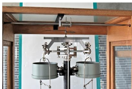
Widoczne koniki i tłumiki
