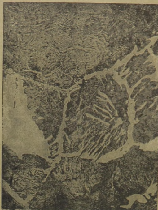
V = 150 Abb. 22 A. Überhitzungsgefüge eines Königshakens nahe der Bruchstelle.
