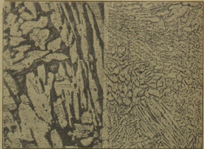
V = 165 9/10 Abb. 11. Das Gefüge einer Preßmessingstange, links: sehr große Kristalle, rechts: feine Kristalle.
