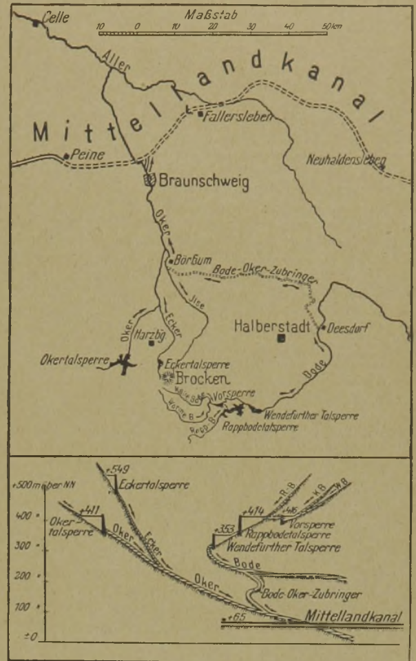
Abb. 3. Speisung des Mittellandkanals aus Harzgewässer nach dem Entwurf von 1920
