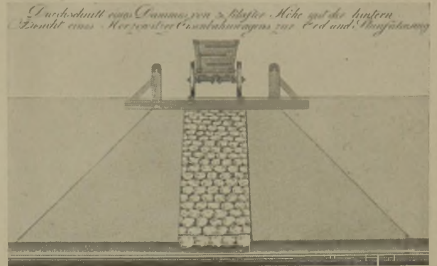
Bild 8: Durchschnitt eines Eisenbahn-Dammes
