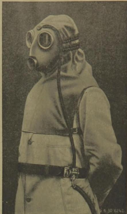
Abb. 9. Druckschlauchgerät in Verbindung mit Sandstrahl-Schutzhaube. Vor dem Mund Ausatemventil. Frischluft aus Preßluftleitung
