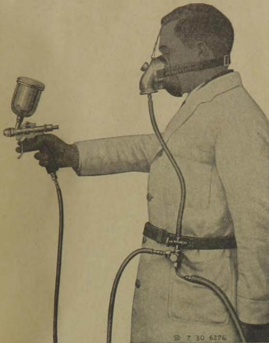
Abb. 8. Druckschlauchgerät in Verbindung mit Halbmaske. Für Lackierereien, wenn beim Lackieren großer Gegenstände die vorhandene Absaugung unzureichend ist. Frischluft wird aus der Preßluftleitung für die Spritzpistole entnommen und kann vom Arbeiter selbst nach Bedarf eingestellt werden.
