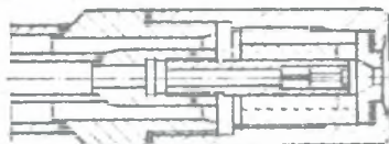
Rys.7 Rozpylacz ciśnieniowy z regulowanym polem przekroju kanałów stycznych.
