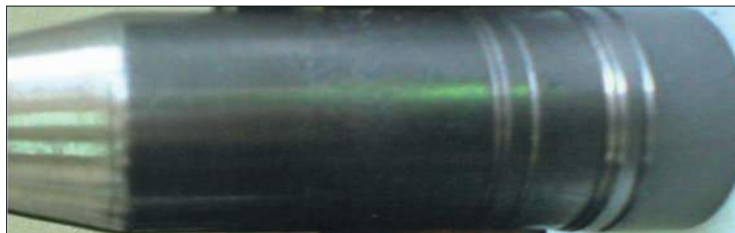
Rys. 13. Fragment korpusu nr 2 po dwukrotnym zgniataniu
