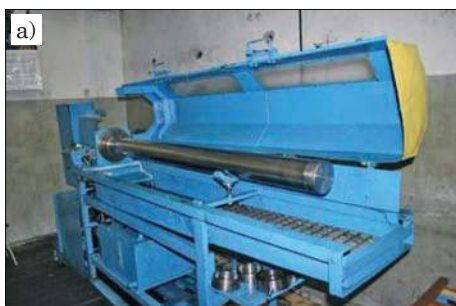
Rys. 10. Stanowiska do badań hydrodynamicznych korpusów ze stali 15CrMoV6-10-3 (a) i ze stali maraging (b)
