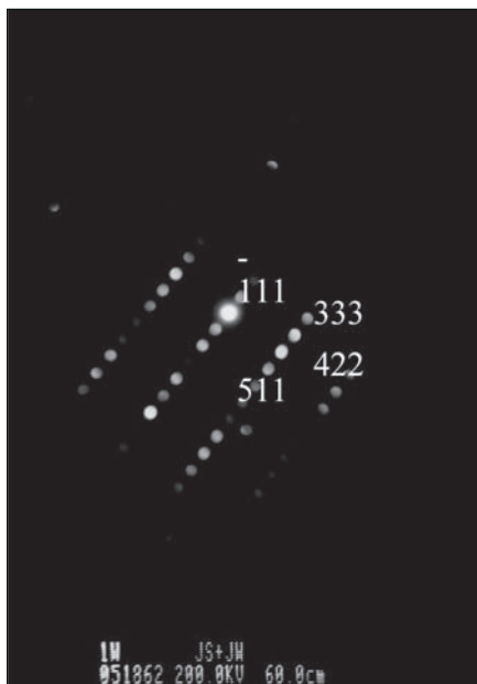
Rys. 94. Wydzielenia dyspersyjne w stali 15CrMoV6-10-3-VAD
