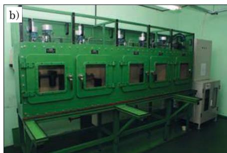
Rys. 10. Stanowiska do badań hydrodynamicznych korpusów ze stali 15CrMoV6-10-3 (a) i ze stali maraging (b)
