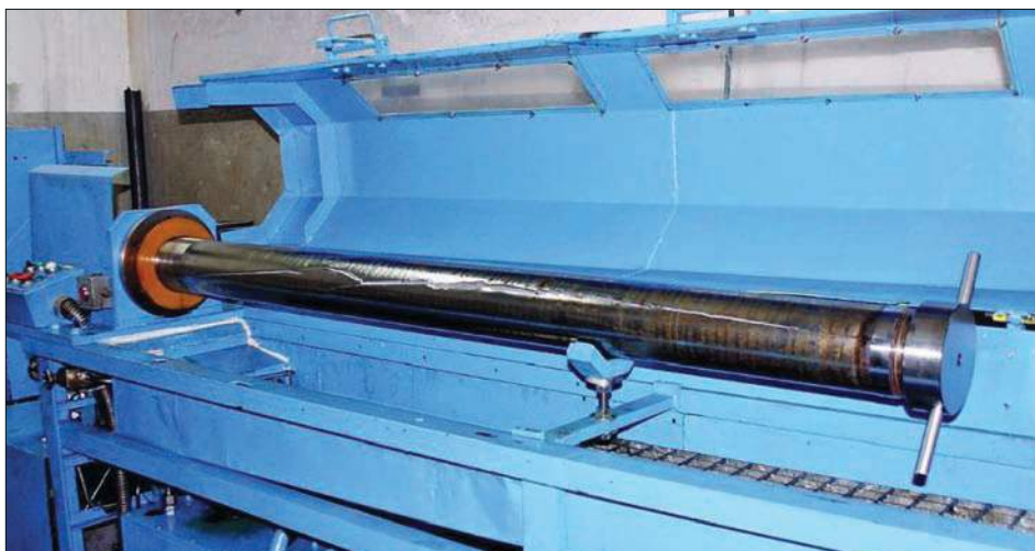
Rys. 78. Widok korpusu ze stali 15CrMoV6-10-3-VAD+EŻP po próbie niszczącej na stanowisku do badań hydrodynamicznych
