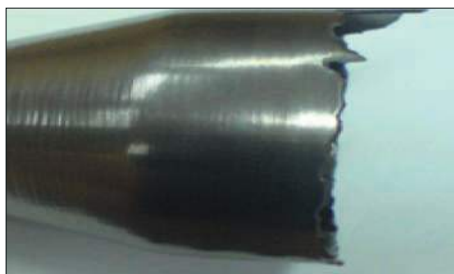
Rys. 12. Fragment korpusu nr 1 po zginiataniu obrotowym
