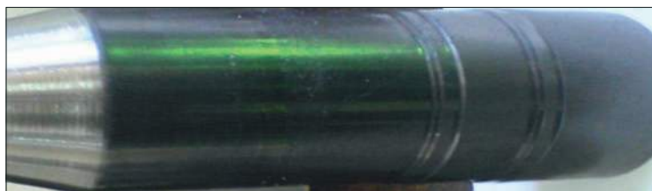
Rys. 14. Fragment korpusu nr 3 po dwukrotnym zgniataniu
