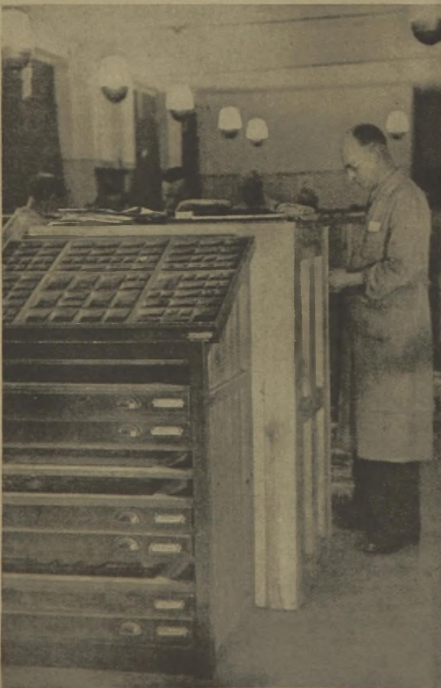
Handsezerei mit indirekter Beleuchtung. Gemessene mittlere Beleuchtungsstärke 200 Lux bei einer Gleichmäßigkeit von 1:0,9
