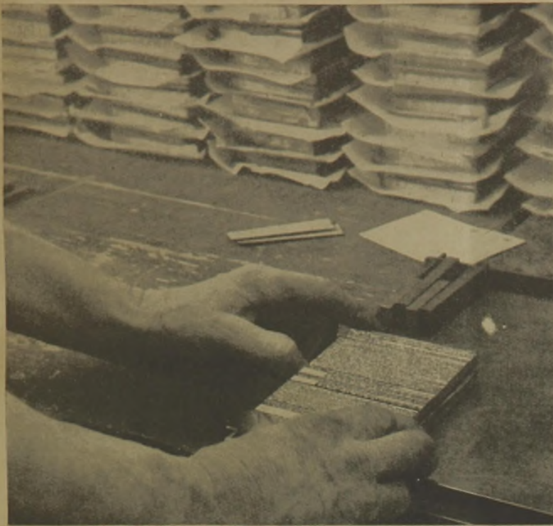
Arbeitsplatz des Setzers beim Justieren der Seiten. Keine störende Schatten, keine Reflexblendung an den blanken Metalloberflächen
