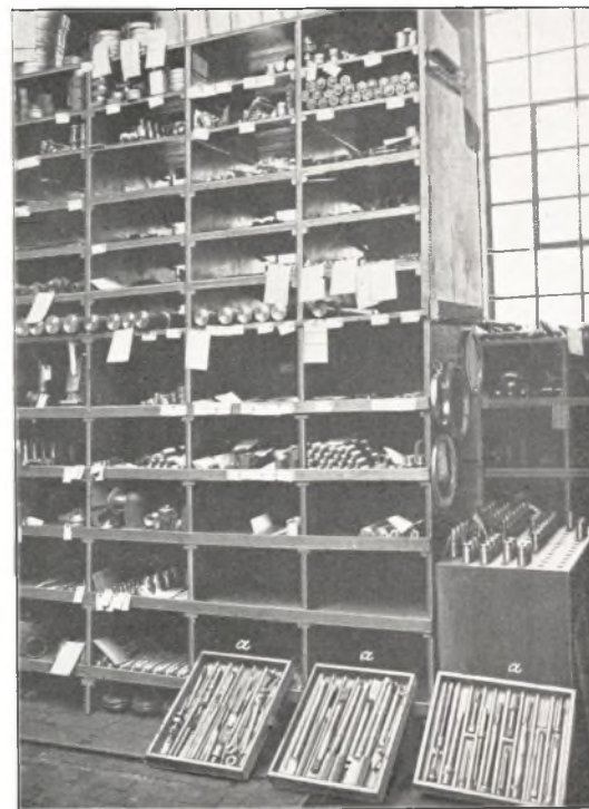
Fig. 16. Zwischenmagazin: Aufbewahrung fertiger Teile. a Spezialwerkzeuge zur Bearbeitung von Dieselmotorenköpfen.
