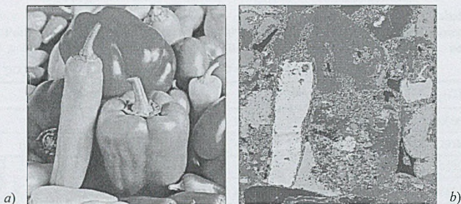
Rys. 1. Obraz testowy Peppers (a) oraz b) przedstawiony w pseudokolorach wynik jego segmentacji dla d = 0,0112 (piksele łączone są w obszary, jeśli ich podobieństwo mierzone w przestrzeni cech \Delta \leq d [1], liczba obszarów n = 62161 – widoczna wyraźna nadsegmentacja obrazu b)
