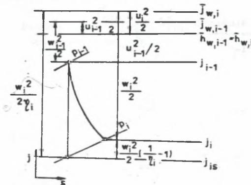
Bild 2. Der Dampfentspannungsprozess im Laufrad Rys. 2. Proces ekspansji pary w wirniku
