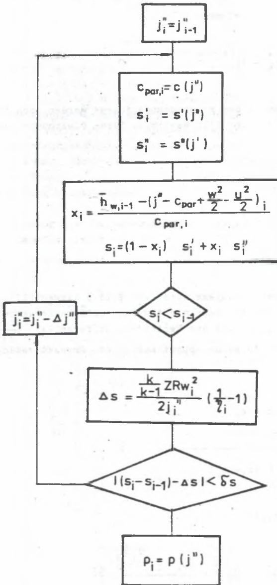
Bild 3. Das allgemeine Blockschaubild der Berechnung den Parametern des Endpunkts von Dampfentspannungsprozess
