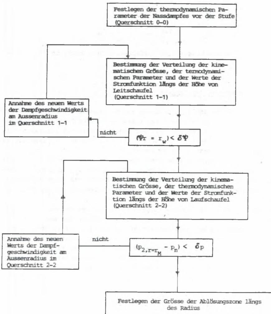
Bild 4. Dass allgemeine Blockschaubild von Berechnungsalgorithmus der Strömung in der Stufe bei Teillast
