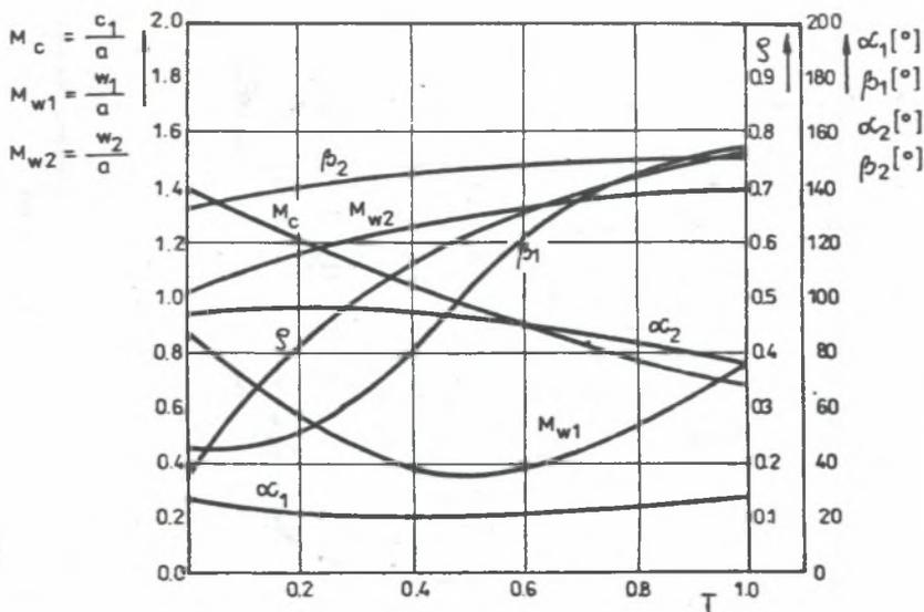
Bild 5. Verteilung der Geschwindigkeiten, der Winkel und Stufenreaktion in verschiedenen Ebenen bei der nominalen Stufenarbeit
