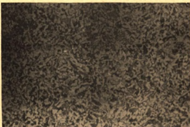
Rys. 10. Mikrostruktura normalizowanego z t^{\circ} 860^{\circ}\text{C} staliwa węglowego (035 L). Pow. \times 150 ; traw. — \text{HNO}_3
