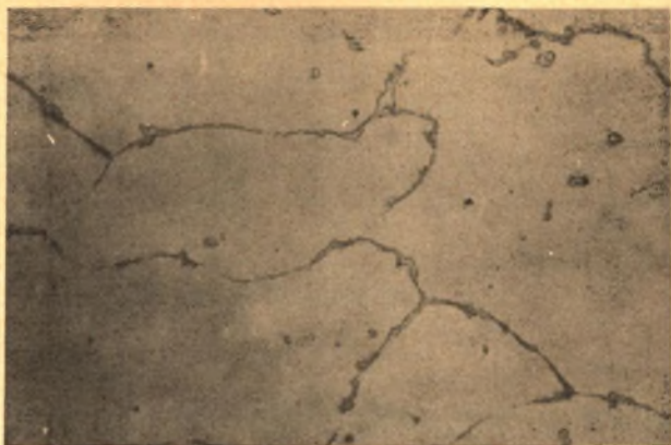
Rys. 8. Mikrostruktura staliwa Hadfielda — bez obróbki cieplnej. Pow. \times 150 ; traw. — \text{FeCl}_3
