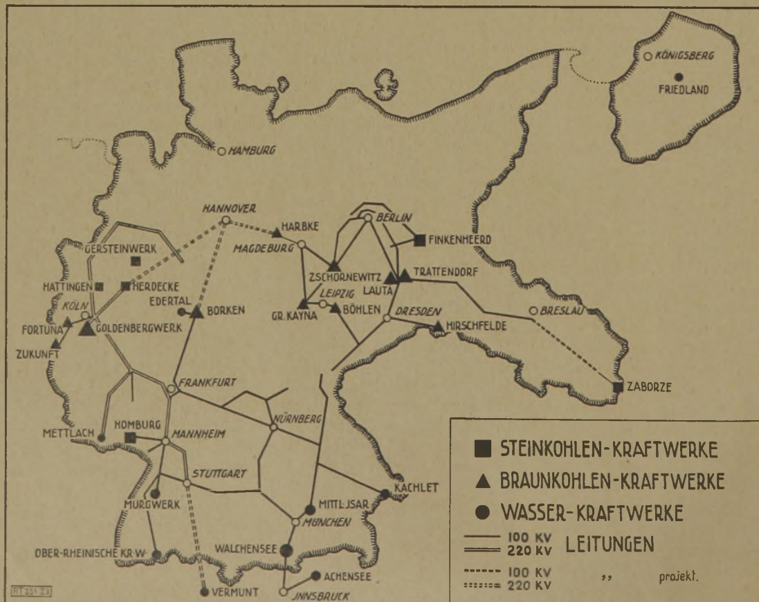
Abb. 3. Elektrizitätserzeugung an der Energiequelle
