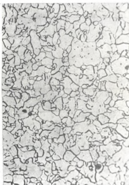
Rys.14. Struktura stali nieuspokojonej o zawartości 0,03% C obrabionej cieplnie. Traw.kw.azot. Pow. x 100 i 500
