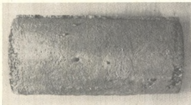
Rys.5. Próbką dobrze oczyszczona (widać pęknięcia odsłonięte po oczyszczeniu); t^{\circ} = 480^{\circ} \text{C} ; 8 \text{ A/dcm} ; 3,5 \text{ V} ; 15 \text{ min.} ; NaOH
