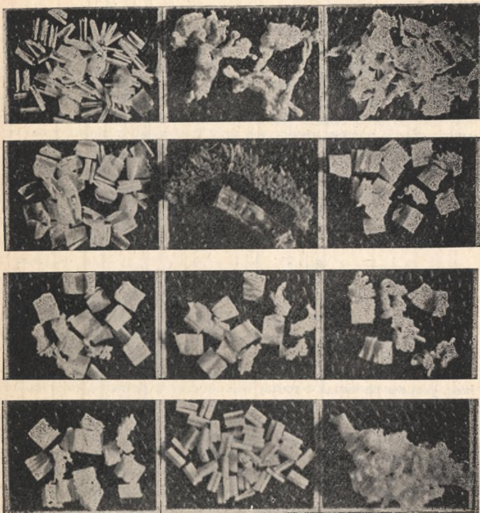
Rys. 12. Wpływ stopnia stępienia, posuwu oraz głębokości frezowania na kształt i rodzaj wiórów
