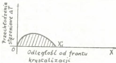
Rys. 7. Zależność przechłodzenia stężeniowego od odległości od frontu krystalizacji
