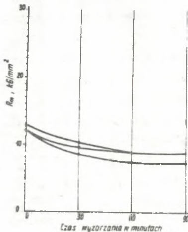
Rys. 2 - Zmiana wytrzymałości na rozciąganie w procesie wyżarzania żeliwa stosowanego wg zaleceń R.W.P.G. na odlewy autoklawów
