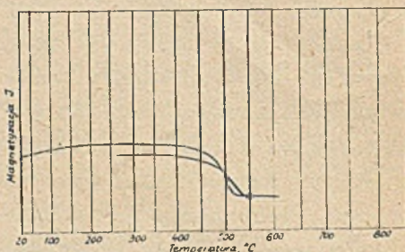
Rys. 6. Zmiany magnetyzacji stali walcowanej ze zgniotem 58% w czasie nagrzewania i wygrzewania w temperaturze 550^{\circ}\text{C} przez 15 godzin, nagrzewania do ok. 610^{\circ}\text{C} i studzenia do ok. 260^{\circ}\text{C}
